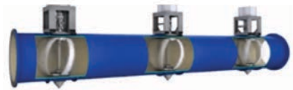
Hình 1. Tuabin thủy điện trong đường ống nước [2]
