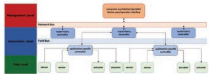
Hình 1: Sơ đồ nguyên lý hệ thống điều khiển tự động hoá toà nhà
